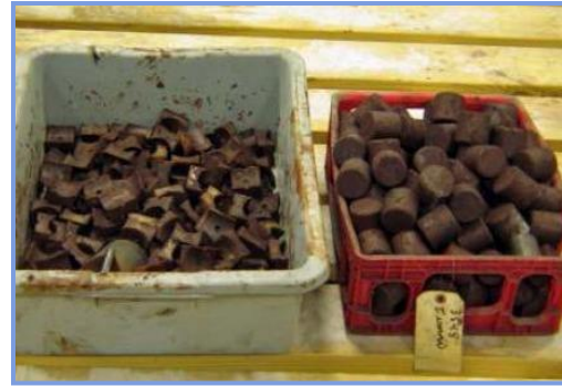
Figura 1 - Ralla di rotazione a rulli incrociati con dentatura esterna: Anelli, rulli e distanziali ricevuti per la riparazione.
