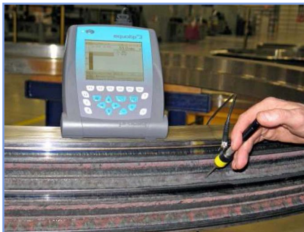
Figura 3 – Misura della durezza della pista di rotolamento
