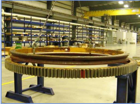
Figura 1 - Ralla di rotazione a rulli incrociati con dentatura esterna: Anelli, rulli e distanziali ricevuti per la riparazione.
